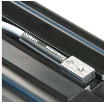
Die RSA- und GSA-Produkte bieten eine große Auswahl an Sensoren. Es stehen 12 Schalter zu Auswahl: Reed, Solid State PNP (Stromquelle) oder Solid State NPN (Stromsenke); als Schließer oder Öffner; mit freien Leitungen oder Schnelltrennung.
